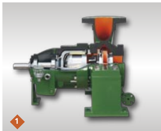
Centrifugaalpompe type PRM volgens API 685 Met magneetkoppeling.
