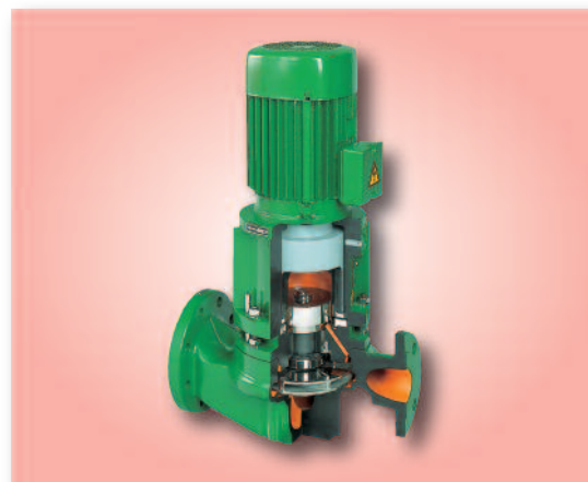
Verticale inline centrifugaalpompe type KMV/NCV Met magneetkoppeling of mechanische asafdichting.
